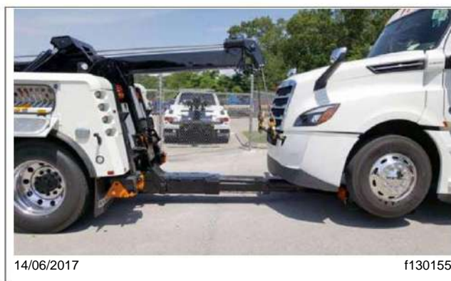
Fig. 26.12, Stinger con adaptadores de elevación debajo del eje (se muestra una grúa)
