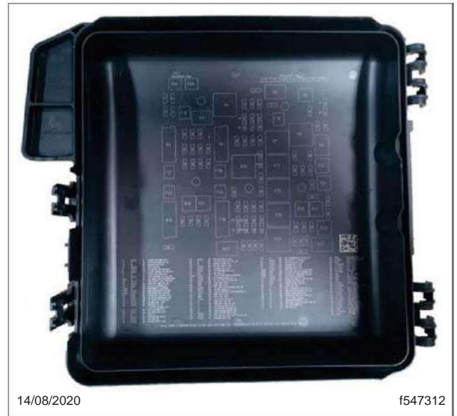
Fig. 11.7, VPDM Interior de la cubierta Mapa de fusibles y relés
