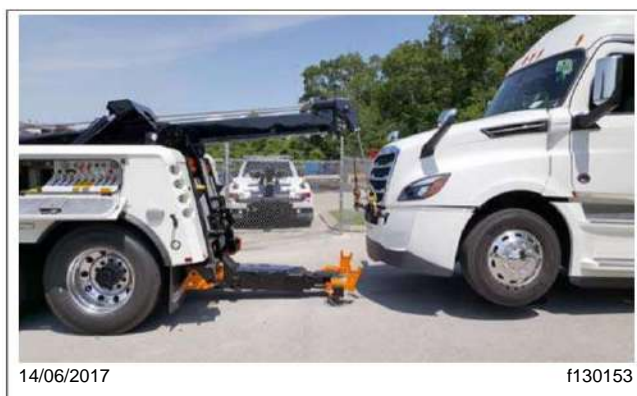
Fig. 26.10, Retroceso del camión de remolque con adaptadores de elevación en la barra transversal
