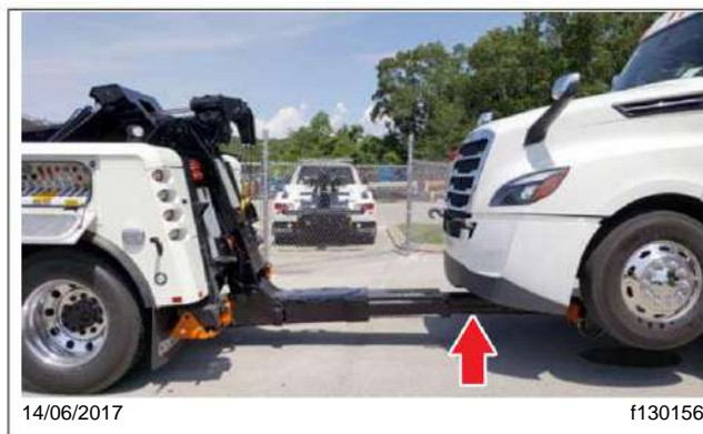
Fig. 26.13, Retracción de la pluma de recuperación
