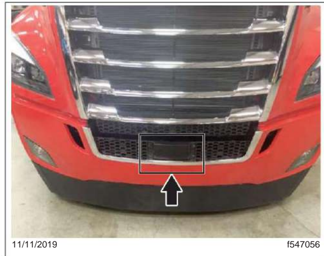
Fig. 6.2, Ubicación del radar delantero
