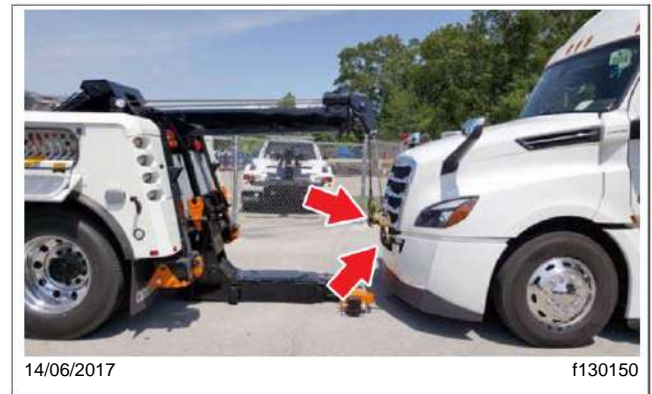
Fig. 26.7, Cables de remolque conectados a los ganchos de remolque
