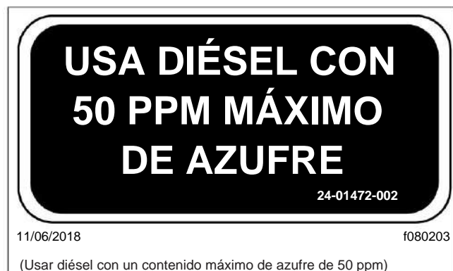
Fig. 14.1, Etiqueta del motor Euro V (se muestra la etiqueta del motor Detroit)
