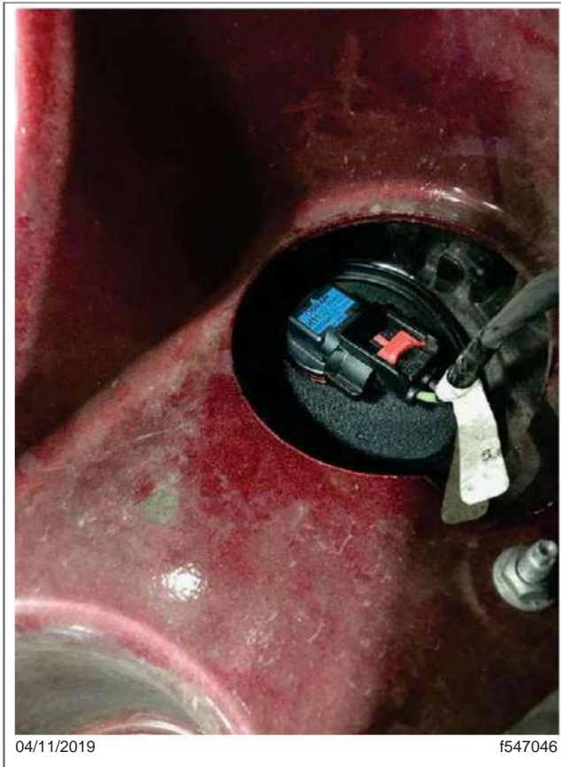
Fig. 22.9, Instalación correcta de faros halógenos con arandela de espuma
