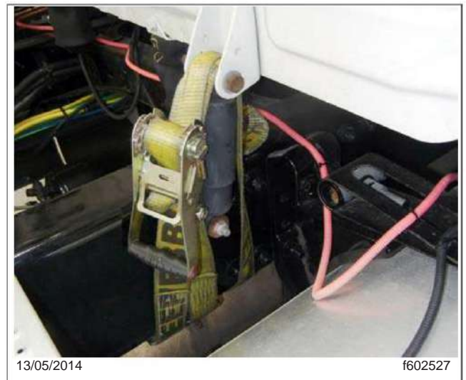
Fig. 26.16, Correa de tensión instalada para sujetar la cabina
