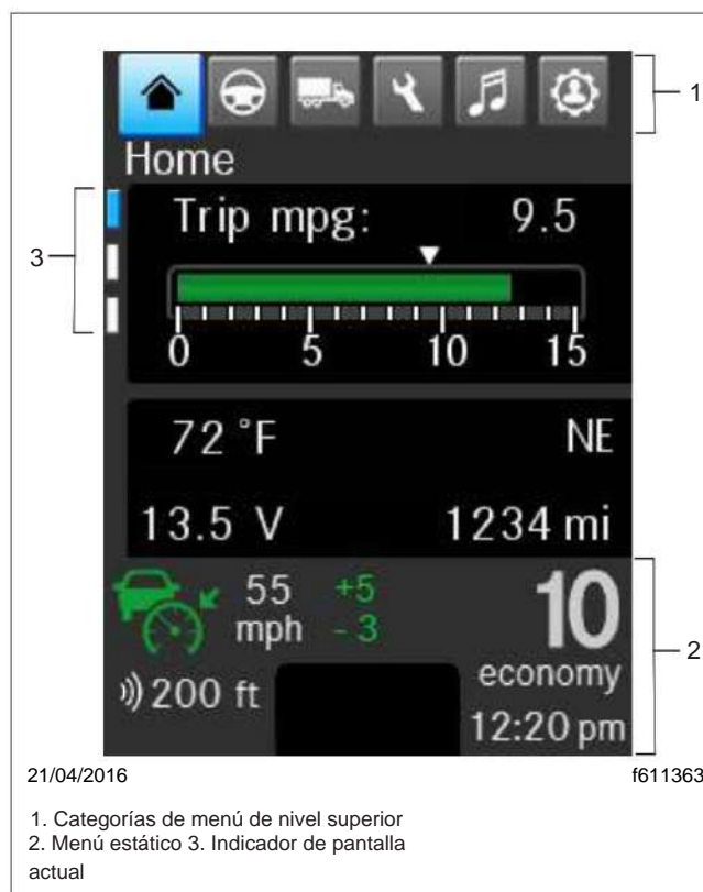
Fig. 3.2, Pantalla del controlador ICUC
