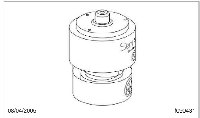
Fig. 3.34, Indicador de restricción de aire de restablecimiento manual, pasa/no pasa
