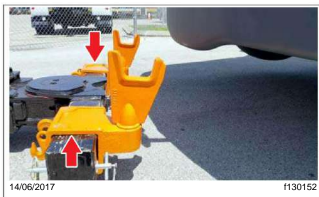
Fig. 26.9, Adaptadores de elevación instalados en la barra transversal
