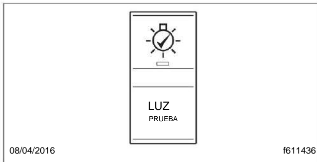
Fig. 25.8, Interruptor de prueba de luz previa al viaje
