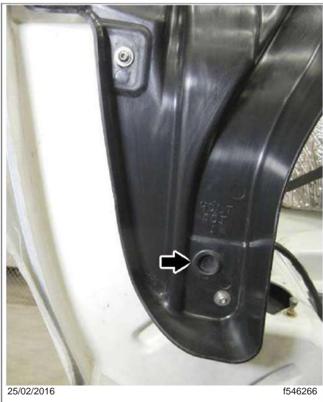
Fig. 22.4, Ajuste de los faros (se muestra con el capó abierto)
