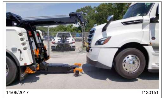
Fig. 26.8, Mover el Stinger y el travesaño debajo del parachoques
