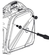
Figura 4-3. Retire la cubierta lateral 3. Desconecte
