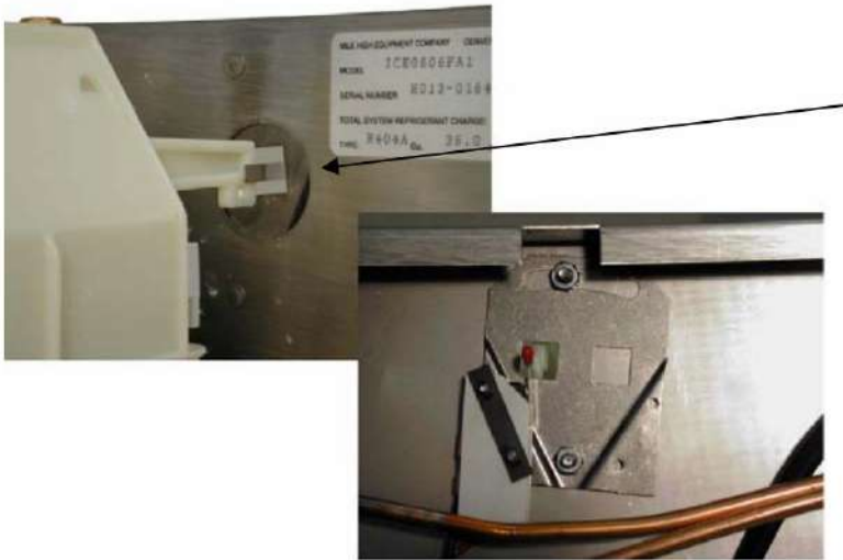
Posición correcta del actuador del interruptor de pacas de alambre
