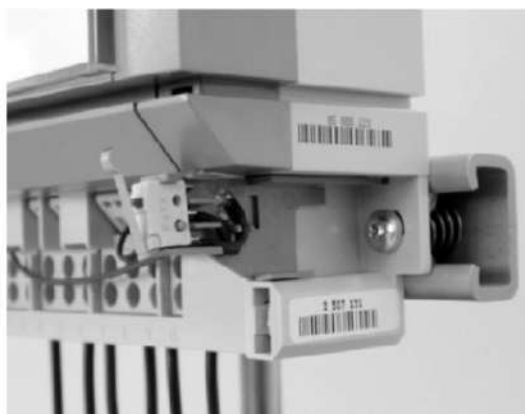
Figura 50 Fijación de la unidad de detección de tapa al medidor
