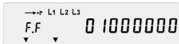
Figura 57 Ejemplo de mensaje de error (tensión de batería insuficiente)
