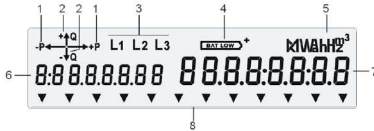
Figura 55 Diseño básico de la pantalla de cristal líquido (LCD)
