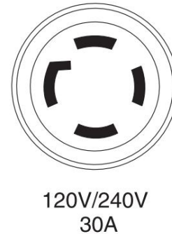
Figura 7 - Salida de 120/240 voltios CA, 30 amperios
